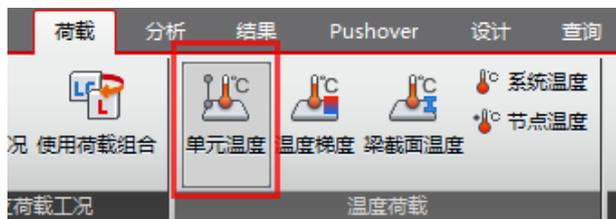
YJK 中的温度荷载转入 midas Gen 中时，自动转为 midas Gen 中的“节点温度”而不是“单元温度”，所以需要把导入 Gen 中的“节点温度”删除之后，重新布置“单元温度”；如果全楼都有温差，也可以设置为系统温度。再将两个软件中的温度应力结果进行对比。
